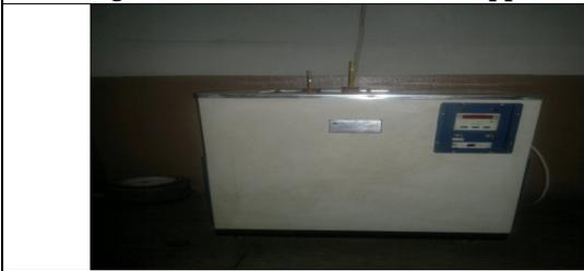
Fig.5. Cloud point & pour point apparatus
